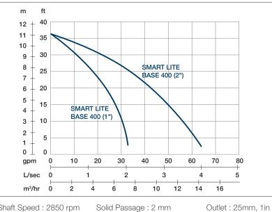
Shaft Speed : 2850 rpm Solid Passage : 2 mm
