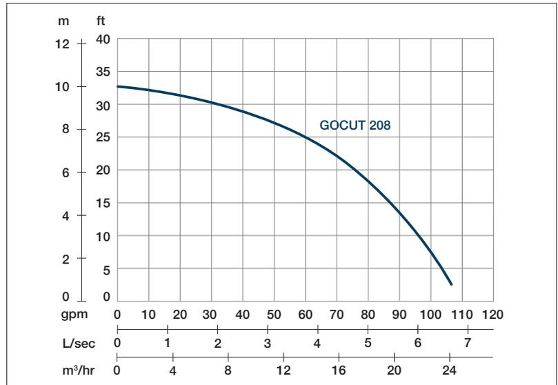
Shaft Speed : 2850 rpm    Solid Passage : 26 mm    Outlet : 50mm, 2in
